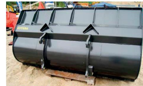
Hytera GS (прямая режущая кромка) и GV (V-образная форма) ковши для гравия созданы для тяжелой работы. Обе модели доступны с опцией зубьев.
